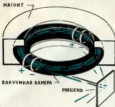
Рис. 2. Свернем линейный ускоритель в кольцо — вот вам и циклотрон. А чтобы частицы послушно бегали по кругу, создадим соответствующее магнитное поле.
